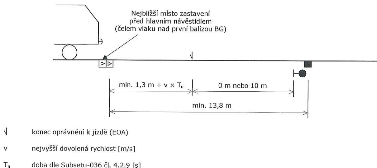
Obrázek 4. Rozmístění balízových skupin před hlavním návěstidlem
